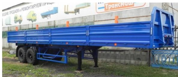
Двухосный, оси BPW, подвеска: рессорная; тормозная система – WABCO; внутренние размеры – 12000\*2480 мм; стальная бортовая платформа высотой 750 мм; передний портал – стальной, усиленный; настил пола – ламинированная влагостойкая фанера (S = 27 мм) с противоскользящим покрытием или рифленый стальной лист; боковые стойки – съемные.
