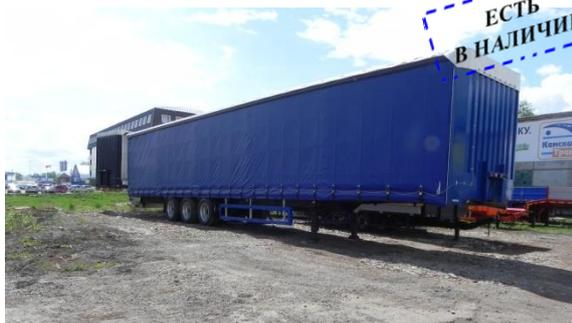
Трехосный шторный полуприцеп с осями BPW, тормозная система – WABCO.
