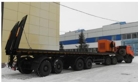
Активный полуприцеп специального назначения с поворотными осями, которые приводятся в движение гидравлическим приводом.
