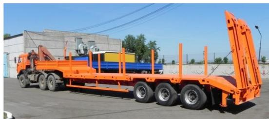
Трехосный трал с осями НЖ (аналог ВРW), тормозная система – WABCO; на гусাকে стальная бортовая платформа высотой 730 мм.
