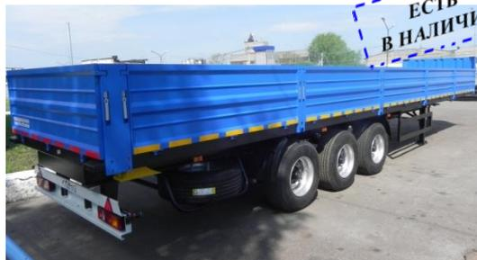
Трехосный бортовой полуприцеп с осями НЖ (аналог ВРW), подвеска: пневмо или рессоры; тормозная система – WABCO; внутренние размеры – 13640\*2480 мм; бортовая платформа: стальная высотой 750 мм; передний портал – стальной, усиленный; настил пола – рифленый стальной лист; боковые стойки – съемные, по желанию клиента возможна установка конников, фитингов.
