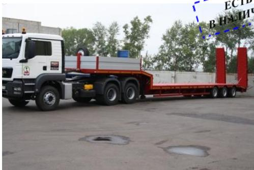
Трехосный трал с осями НЖ (аналог ВРW), тормозная система – WABCO; на гусাকে алюминиевая бортовая платформа высотой 600 мм.
