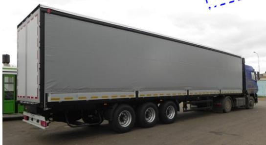
Трехосный шторный полуприцеп с осями НЖ (аналог ВРW), тормозная система – WABCO; алюминиевая бортовая платформа высотой 600 мм; передний портал – стальной, усиленный; настил пола – ламинированная влагостойкая фанера (S=27мм) с противоскользящим покрытием; боковые стойки – сдвижные; шторный механизм VERSUS.
