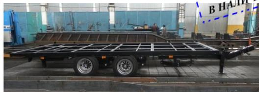
Усиленная рама, выполненная из специальной стали 09Г2С. Конструкция рамы обеспечивает погрузочную высоту 840мм. Прицепы данной серии выполняются на пневмо-подвеске с односкатной ошиновкой.
