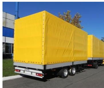
Алюминиевая бортовая платформа, стальной передний портал, быстросъемные средние стойки, задний откидной борт, тент, настил пола – влагостойкая фанера – 27мм, утепленные кольца для фиксации груза – 8шт.
