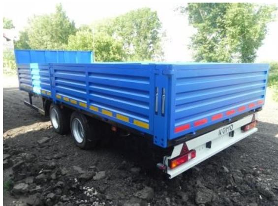
Стальная бортовая платформа с высотой бортов 730мм, стальной передней портал (возможны варианты изготовления по переднему борту), все стойки – съемные, настил пола – рифленая сталь или ламинированная влагостойкая фанера с противоскользящим покрытием толщиной 27мм, утепленные кольца для фиксации груза – 8шт.
