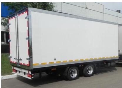
Промтоварный кузов прицепа выполнен из лакированного металла (цвет кузова и обвязки прицепа – на усмотрение клиента).
