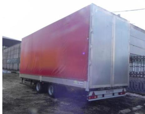
Алюминиевая бортовая платформа, стальной передней портал, быстросъемные средние стойки, задние распашные ворота, тент, настил пола – ламинированная влагостойкая фанера с противоскользящим покрытием толщиной 27мм, утепленные кольца для фиксации груза – 12шт.
