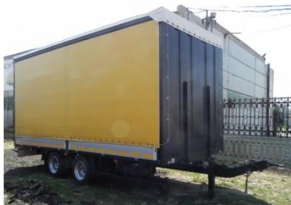
Алюминиевая бортовая платформа, стальной передний портал, сдвижные средние стойки, задние распашные ворота, тент, настил пола – влагостойкая фанера – 27мм, утепленные кольца для фиксации груза – 8шт. Шторный механизм (независимая загрузка через бока, так и крышу).
