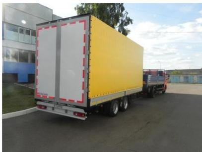
Алюминиевая бортовая платформа, стальной передний портал, быстросъемные средние стойки, задние распашные ворота, тент, настил пола – влагостойкая фанера – 27мм, утепленные кольца для фиксации груза – 8шт.
