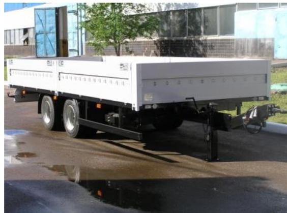
Алюминиевая бортовая платформа с высотой бортов 600мм (возможны варианты изготовления по переднему борту), все стойки – съемные, настил пола – рифленая сталь или ламинированная влагостойкая фанера с противоскользящим покрытием толщиной 27мм, утепленные кольца для фиксации груза – 8шт.
