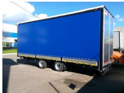
Алюминиевая бортовая платформа, стальной передний портал, сдвижные средние стойки, задние распашные ворота, тент, настил пола – влагостойкая фанера – 27мм, утепленные кольца для фиксации груза – 12шт. Шторный механизм (независимая загрузка через бока, так и крышу).
