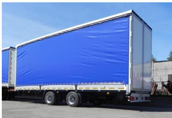
Алюминиевая бортовая платформа, стальной передней портал, сдвижные средние стойки, задние распашные ворота, тент, настил пола – влагостойкая фанера – 27мм, утепленные кольца для фиксации груза – 12шт.
