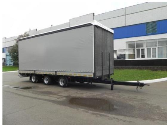
Алюминиевая бортовая платформа, стальной передней портал, сдвижные средние стойки, задние распашные ворота, тент, настил пола – ламинированная влагостойкая фанера (S = 27 мм) с противоскользящим покрытием, утопленные кольца для фиксации груза – 14 шт., Шторный механизм, позволяющий производить независимую загрузку через бока и крышу.
