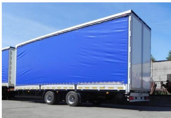
Алюминиевая бортовая платформа, стальной передней портал, сдвижные средние стойки, задние распашные ворота, тент, настил пола – ламинированная влагостойкая фанера (S = 27 мм) с противоскользящим покрытием, утопленные кольца для фиксации груза – 8шт., Шторный механизм, позволяющий производить независимую загрузку через бока и крышу.
