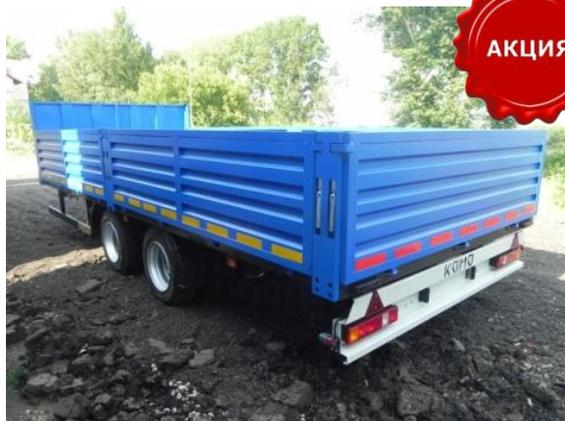
Стальная бортовая платформа с высотой бортов 730мм, стальной передней портал, все стойки – съемные, настил пола – рифленая сталь или ламинированная влагостойкая фанера (S = 27 мм) с противоскользящим покрытием, утопленные кольца для фиксации груза – 8 шт.
