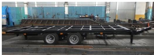
Усиленная рама, выполненная из специальной стали 09Г2С. Конструкция рамы обеспечивает погрузочную высоту 837 мм. Прицепы данной серии выполняются на пневмо-подвеске с двухскатной ошиновкой.
