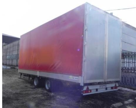
Алюминиевая бортовая платформа, стальной передней портал, быстросъемные средние стойки, задние распашные ворота, тент, настил пола – ламинированная влагостойкая фанера (S = 27 мм) с противоскользящим покрытием, утопленные кольца для фиксации груза – 8 шт.
